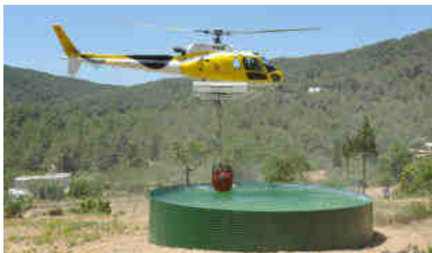
Un helicóptero contra incendios mete el 'bambi' en un depósito de agua.
